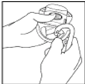
Fig C 2 - Agganciare il moschettone del connettore nell'occhiello di battuta del carrello.
